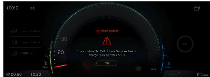
Ako dođe do kritičnog kvara što je vrlo rijetko, parkirna kočnica se ne može otpustiti i motor se ne može pokrenuti. Obratite se vašoj servisnoj radionici. Napomena! Gotovo sve slučajevе kvara podrška može popraviti na daljinu.
